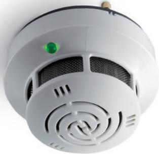
Hekatron Rauchschalter erfüllen bereits die DIN 14677-1: 2018. Die Revisions- bzw. Serviceanzeige des optischen Rauchschalters signalisiert nach 8 Jahren die Notwendigkeit eines Meldertauschs. Hekatron Rauchschalter ORS 142 sind zu Vorgängermodellen (z. B. ORS 132) kompatibel. Das macht eine kostengünstige und schnelle Modernisierung möglich, ohne die gesamte Anlage zu ersetzen.
